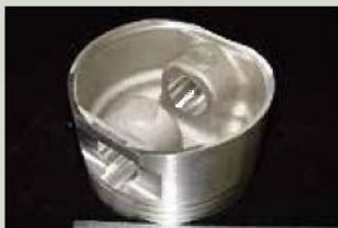
ピストン 自動車用ピストン（試作）
